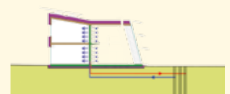
Geothermie Kühlung und Heizung, Bauteilaktivierung
